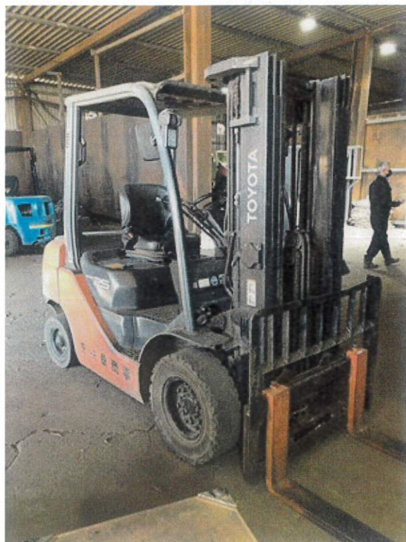
④フォークリフト（トヨタ社製 02-8FD25 最大揚高 4.5m）
